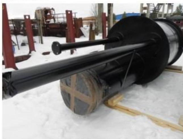
Для долговечности емкости для канализации можно использовать коррозионностойкие марки стали (сталь 12Х18Н10Т).
