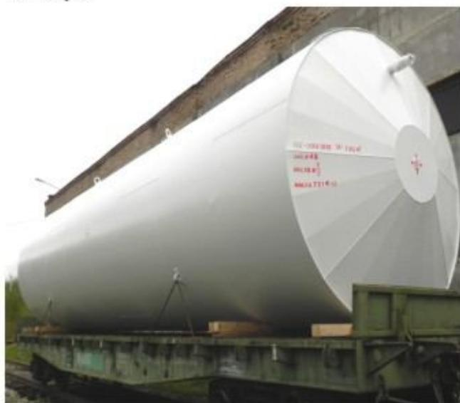
Конструктивная особенность двустенных резервуаров заключается в расположении основной емкости внутри предохранительной. Это дает возможность предохранить основную емкость от агрессивного воздействия грунтовых вод и увеличить срок его службы до 50 лет.
