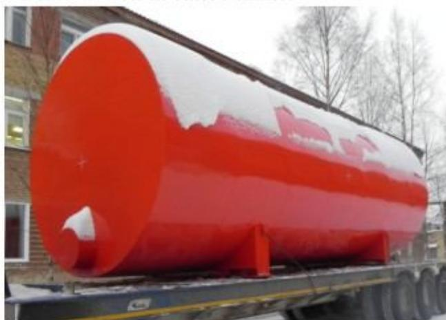
Для хранения вязких нефтепродуктов и для предотвращения загустения хранимой жидкости РНГ оборудуют подогревающими устройствами:
