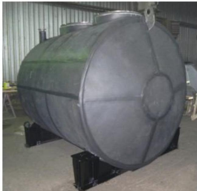
Из-за того, что величины вылетов люков и горловин подземной емкости могут составлять 1м и более, чтобы транспортирование сделать более удобным и менее затратным к месту монтажа, мы согласуем с заказчиком возможность доставки горловин отдельно от самого сосуда. Горловины срезаются на расстоянии, равном 0,2,-0,4м от обечайки и крепятся при монтаже путем фланцевого соединения или сваркой.
